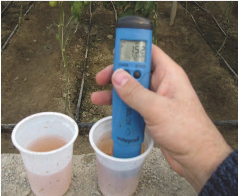
شکل ۱۹- تنظیم EC و pH قبل و بعد از کودآبیاری به منظور جلوگیری از خسارت نمک و گرفتگی قطره‌چکان‌ها و تعیین بهتر مقدار عناصر و کودها در محیط خاک
